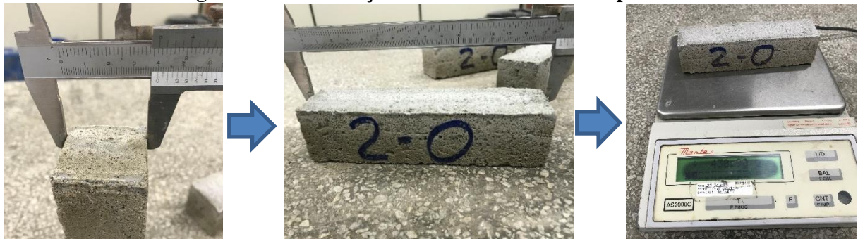
Figura 8 - Determinação da densidade de massa aparente
