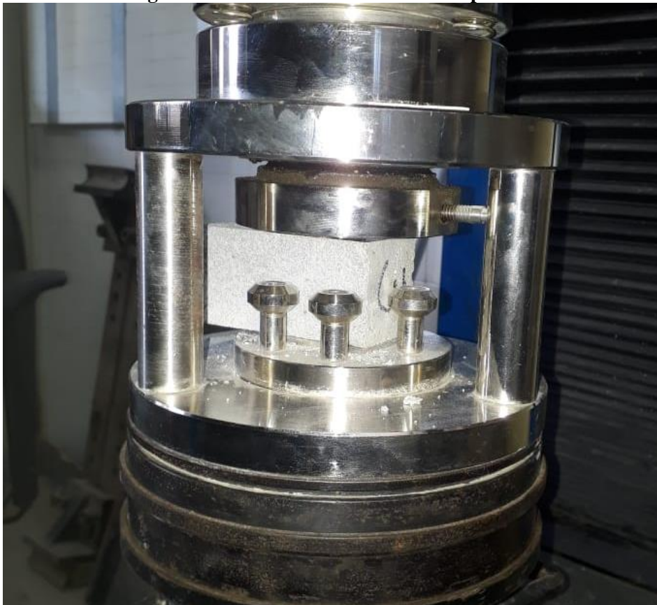
Figura 11 - Ensaio de resistência à compressão
